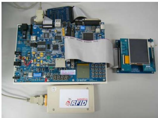
圖 2 雛型設計之實際系統架構
